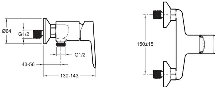
Спецификация продукта: Настенный смеситель. E29843. Коллекция: OSCAR. ВЕС: 1,5 кг. МАТЕРИАЛ: N/A. ТИП УСТАНОВКИ: Крепление к стене. ТИП: Однорычажный. РАСХОД ВОДЫ: 5 л/мин. УСТАНОВКА: Настенные. ГАРАНТИЯ НА ОТДЕЛКУ: 10 лет.
